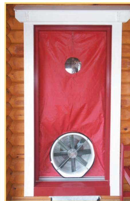
Messung mit Blower-Door-Verfahren.
