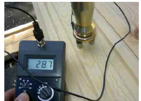
Bild 2: Diese gemessene Feuchtigkeit ist eindeutig zu Hoch
