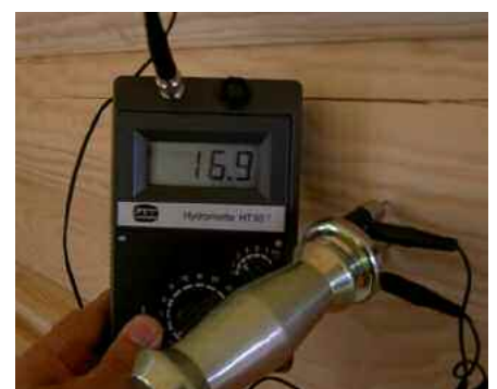
Bild 2: Diese gemessene Feuchtigkeit ist eindeutig zu Hoch
