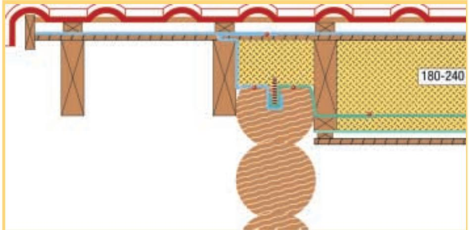
**Bild 5:** Die schematische Darstellung zeigt, wo sich die Abdichtungsstellen (rote Punkte) zwischen Dach, Folie und Blockwand befinden.
